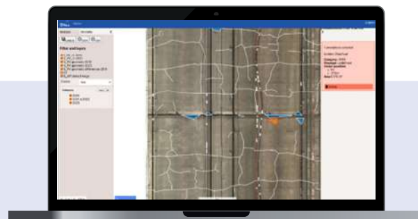
Extraits de l'interface IVON-E avec relevés de défauts avec à droite exemple outil de mesure
